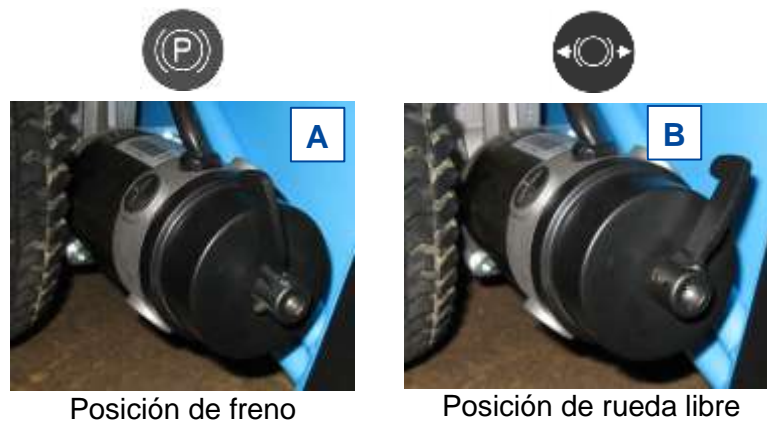
Figura 8 Manejo de la palanca de rueda libre
