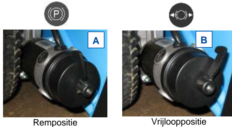
Figuur 8 Bedienung van de vrijloophendel
