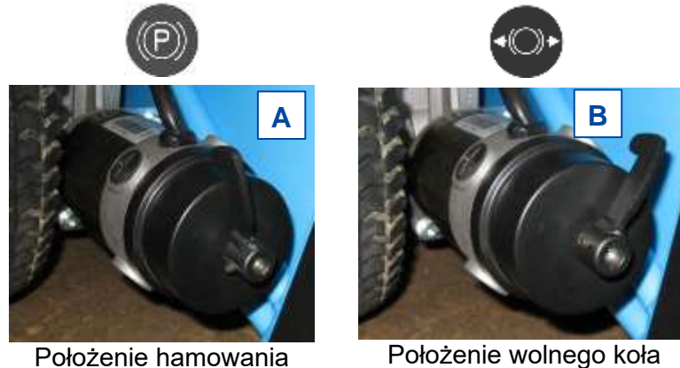
Ilustracja 8 Obsługa dźwigni wolnego koła
