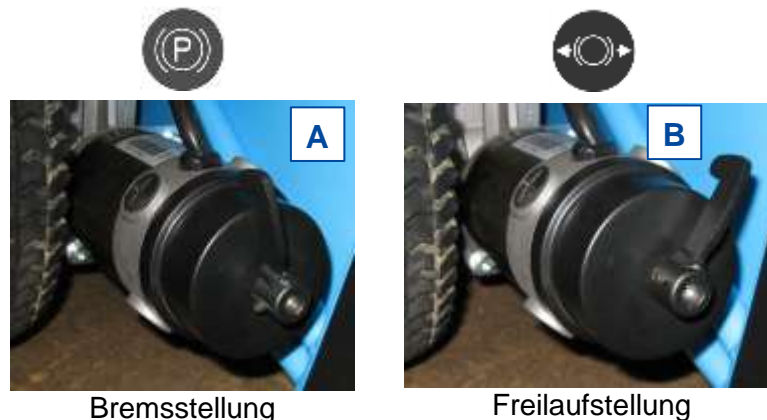
Abbildung 8 Betätigen des Freilaufhebels
