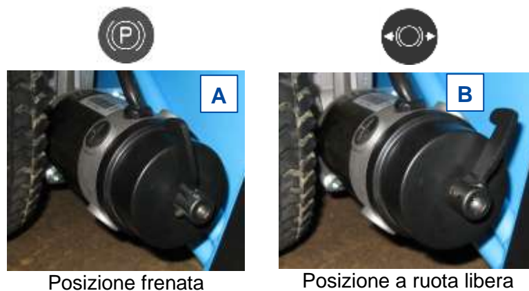
Figura 8 Azionamento della leva di ruota libera
