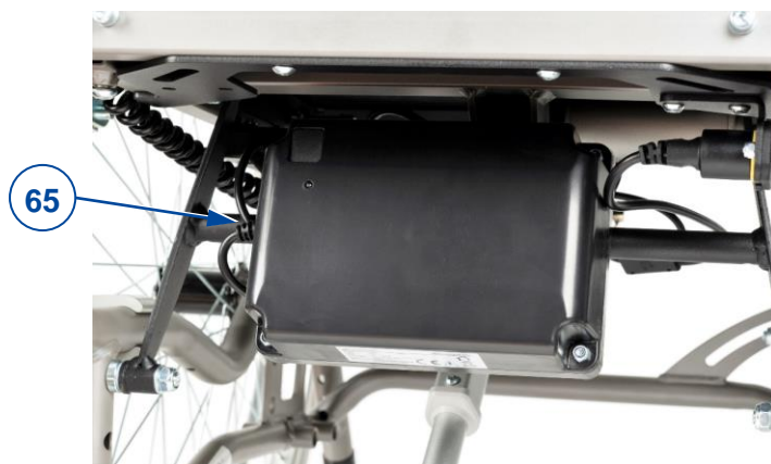
Obrázek 15 Umístění baterie na invalidním vozíku
