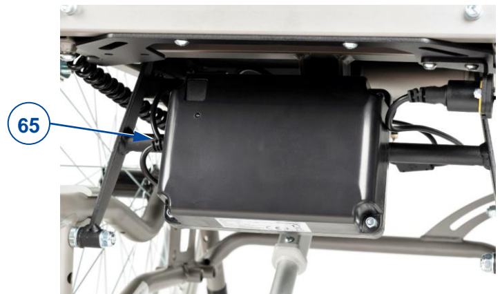
Figuur 15 Batterijlocatie op de rolstoel
