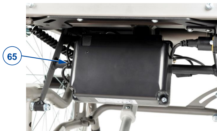
Figure 15 Emplacement de la batterie sur le fauteuil roulant
