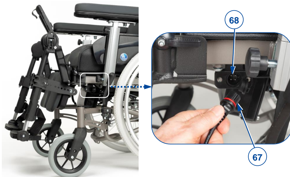
Figura 16 Ubicación del punto de conexión
