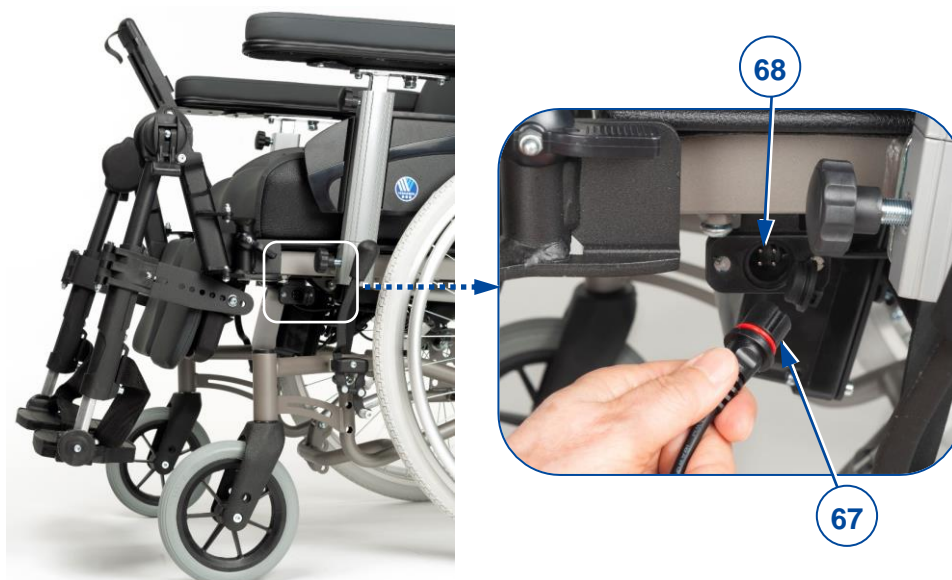
Figure 16 Emplacement du point de connexion
